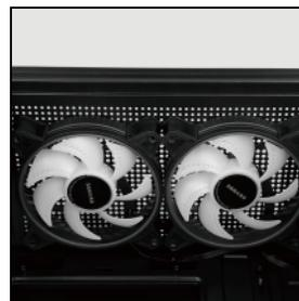
Fixe com os parafusos pela parte de fora do painel superior.
