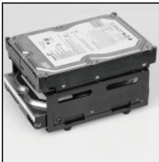
Posicione o segundo HDD na parte interna do suporte, alinhando as furações com as do suporte. Fixe o HDD com parafusos.
